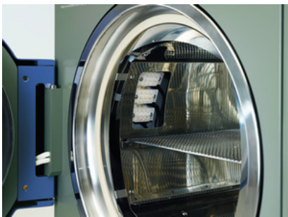
Prüfraum aus hochwertigem Edelstahl: (Prüfraumtür schließt und öffnet sich automatisch per Knopfdruck).
